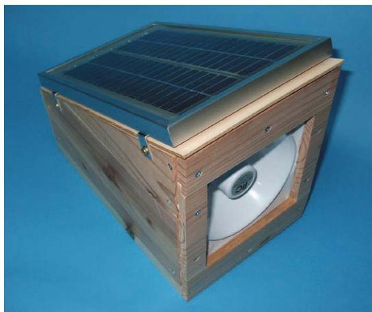
写真2<sup>(1)</sup> 最初にしたカラス撃退機
