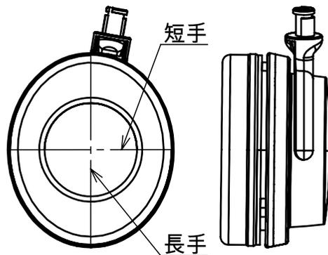
⑤イヤerpッドの縫製部が④バッフルA'ssyに隠れて見えないようにする。
