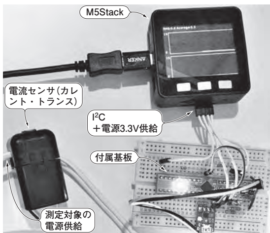
写真1 付属基板を使ってブレッドボード上で組んだIoT電力モニタ
