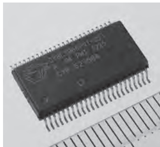
写真 B 20 ビット A-D コンバータを搭載する PSoC 3 CY8C3866P VI-021 (インフィニオン テクノロジーズ)
