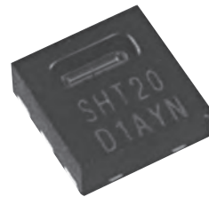
写真1 湿度センサと温度センサが集積化されたワンチップ・センサIC(センシリオン)
