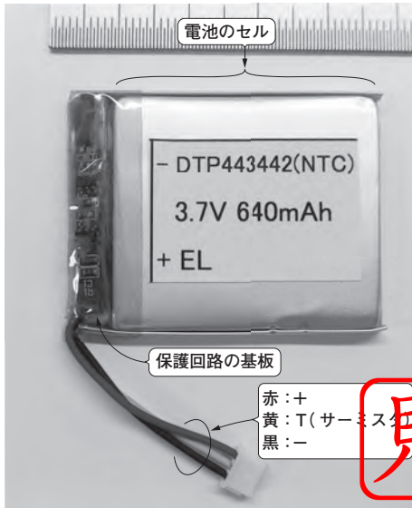
写真1 リチウム・イオン・ポリマ電池は薄くて軽い小型機器の組み込みに使われる。最低限の保護回路が付属している電池パックが入手しやすい。この例では温度測定用のサーミスタも内蔵する
