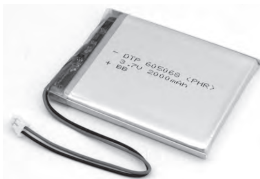
写真1 (1) 市販リチウム・イオン電池DTP605068の仕様(表1)を読み解く
