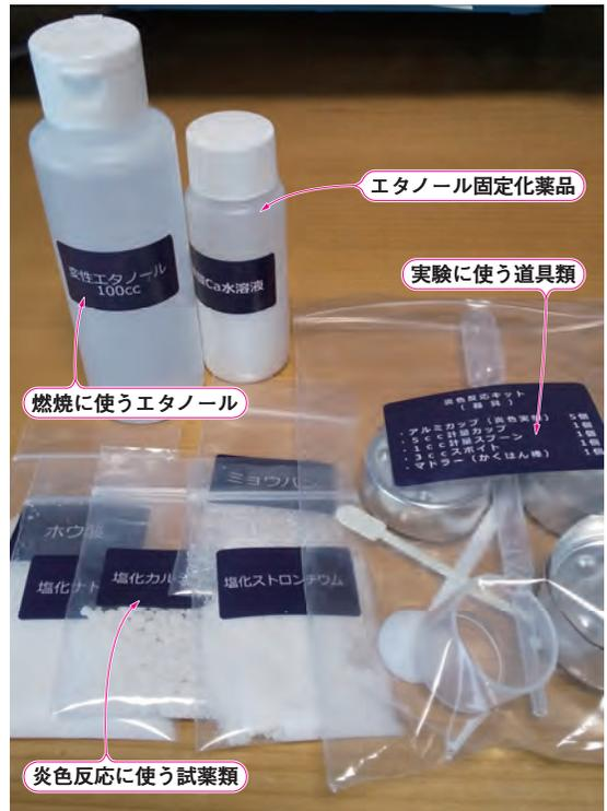
写真2 実験の試薬として今回使った炎色反応実験キット
