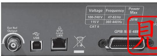
写真1 計測器は実は制御されること前提...たいていGPIBやLANやUSBなどの制御バスが用意されている AFG3252, テクトロニクス
