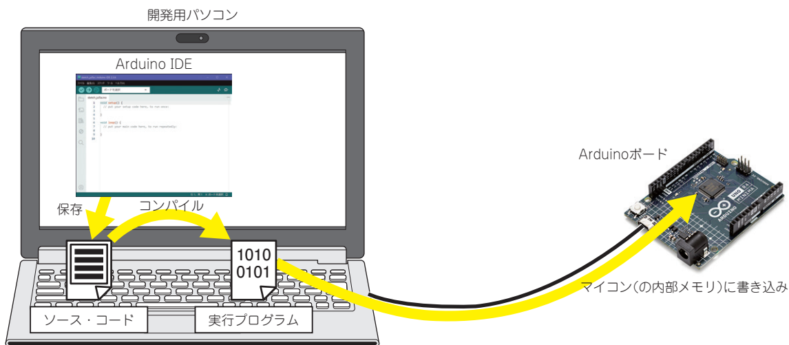
(a) 開発環境Arduino IDE上でプログラムの作成&コンパイルから実行プログラムへのマイコンへの書き込みまですべて行える
