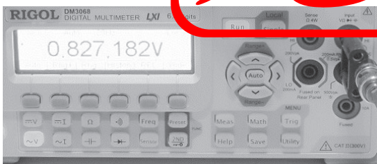
写真1 高級なデジタル・マルチメータは表示桁数が多いそれだけ確度が高いのだが、使い方が悪いと正確さは損なわれる
