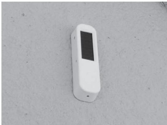
写真9-1 壁に取り付けたSTM431J(温度/湿度センサ)
