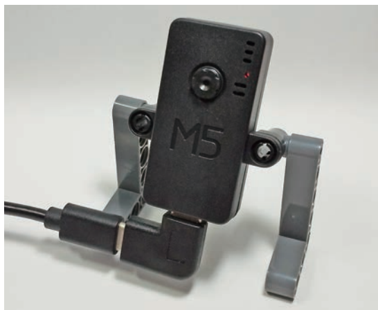
写真1 顔検知や人体検知で写真撮影＆ネット配信。IoTレディM5Camera M5Stack製が開発したWi-Fi搭載カメラ・デバイス。Arduinoを使って、IoT化や機能拡張が可能
