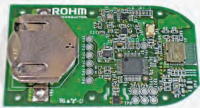
6つのセンサを搭載した小型ユニット、コイン電池1個で数か月間13値のデータBLEで送信できる
