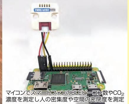
マイコンでスマートフォンのBLEビーコン数やCO<sub>2</sub>濃度を測定し人の密集度や空間の密閉度を測定
