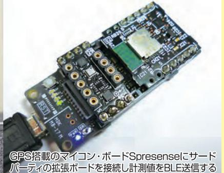
GPS搭載のマイコン・ボードSpresenseにサードパーティの拡張ボードを接続し計測値をBLE送信する
