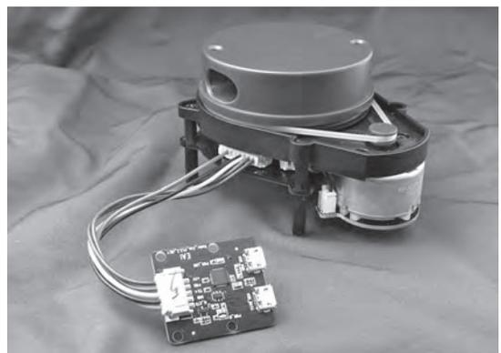
写真1 360度2次元距離測定器YDLiDAR X4
