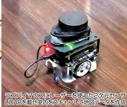
ラズパイマウスにレーザーを使った2次元センサLIDARを載せ室内をスキャンして地図データを作成
