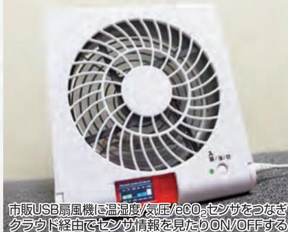
市販USB扇風機に温湿度/気圧/eCO<sub>2</sub>センサをつなぎクラウド経由でセンサ情報を見たりON/OFFする
